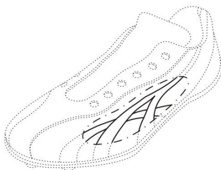
圖 8-12 以虛線表示所應用之球鞋物品，另以一點鏈線表示主張設計之邊界範圍
