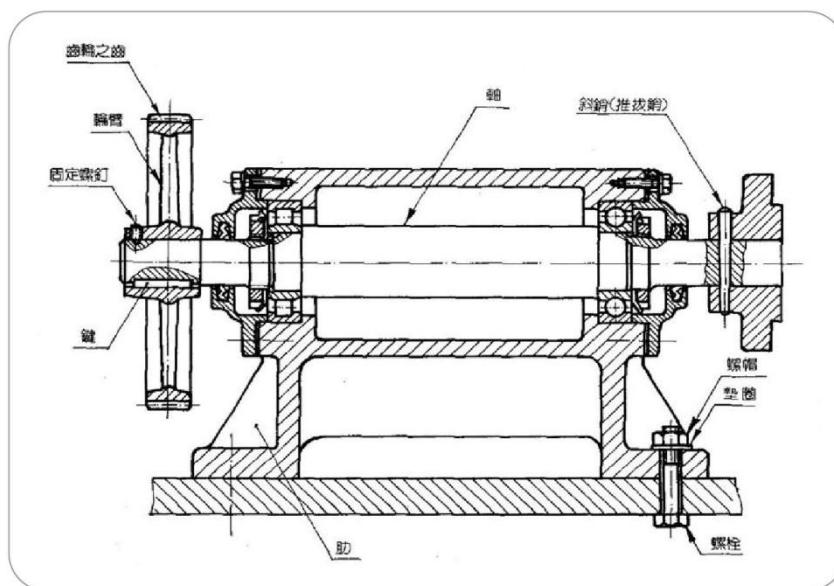
圖 3-12 設計的剖面圖不得做為內部結構或功能構造之說明
