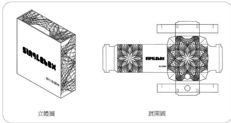
圖 3-16 表現設計展開後的平面狀態
