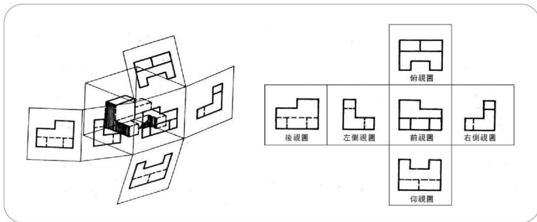
圖 3-9 應依工程製圖的正投影法繪製六面視圖，但不得以虛線來表示物品內部的隱藏線
