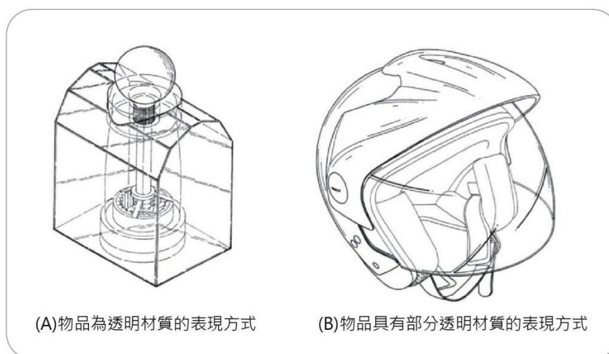
圖 3-40 透明材質的表現方式
