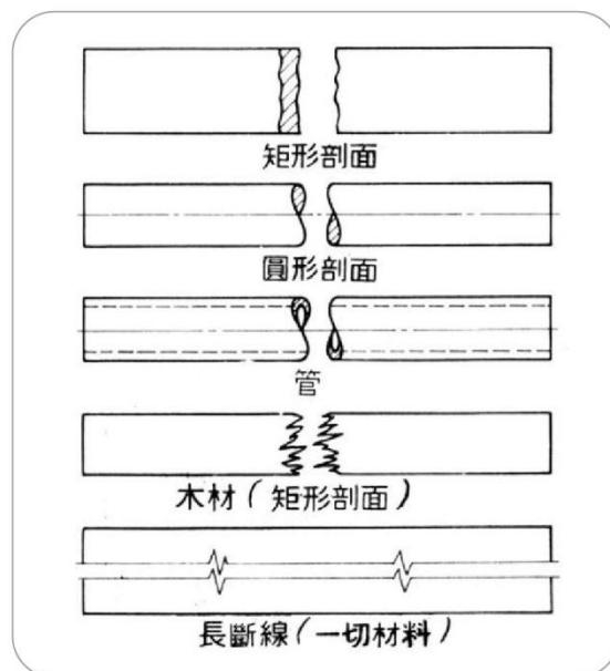
圖 3-43 各種表示斷裂線的方式
