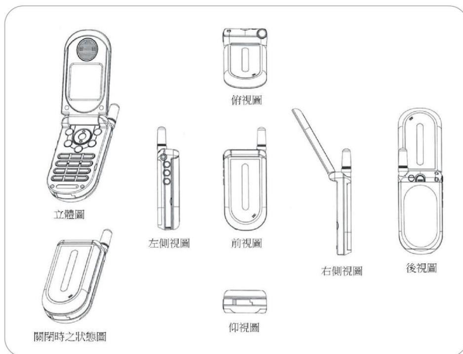
圖 3-23 基本視圖應避免揭露不同的使用狀態
