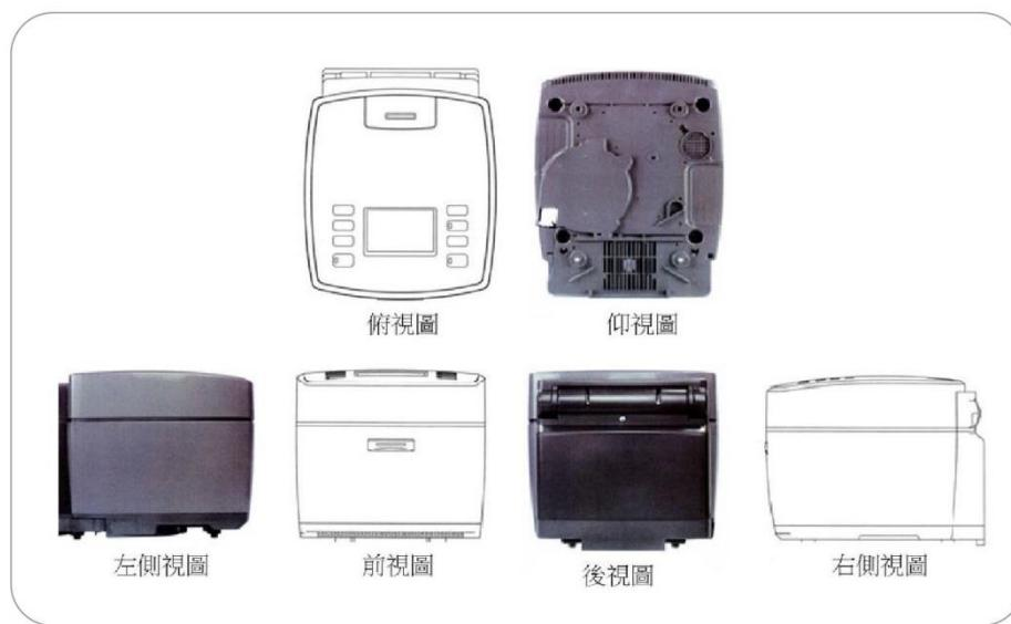
圖 3-30 六面視圖應避免混合不同的揭露方式
